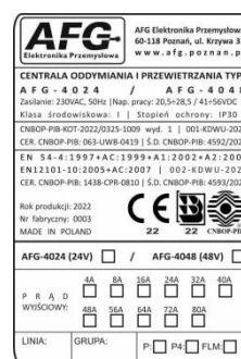
Rysunek 3. Tabliczka: obudowa centrali.
