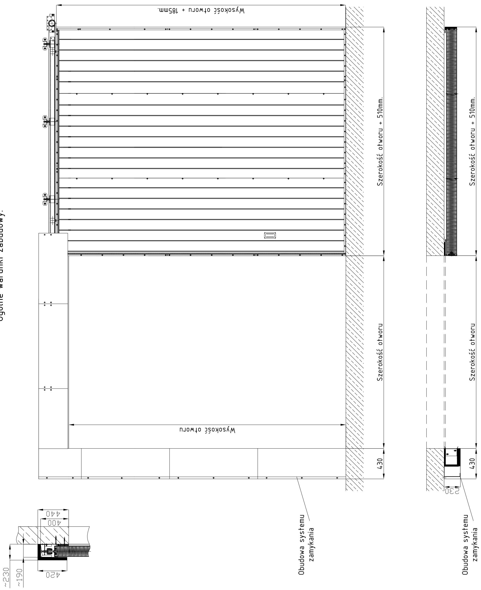
Brama przeciwpożarowa, przesuwna EF N150 EI120, zamkana na prawo. Przeciwcieżar umieszczony po stronie przeciwnej do przymyku.
